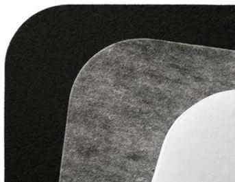
I pannelli Ecobaffle™ sono realizzati in fibra di poliestere PET termoliscia e termolegata ignifuga, e sagomati, mediante taglio meccanico, nella forma e nelle dimensioni richieste.
